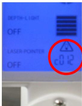
In caso di una funzione difettosa appare sul display un codice errore come in figura.
